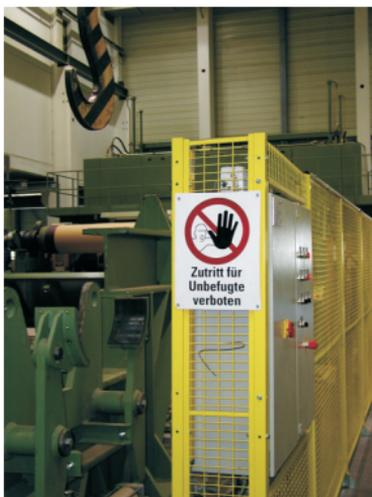
Schutzvorrichtungen dürfen erst unmittelbar vor den Arbeiten entfernt werden und müssen nach Beendigung der Arbeiten sofort wieder montiert werden.
