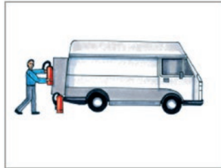
Eingesetzte Feuerlöschern nicht mehr aufhängen, Feuerlöschern neu füllen lassen
